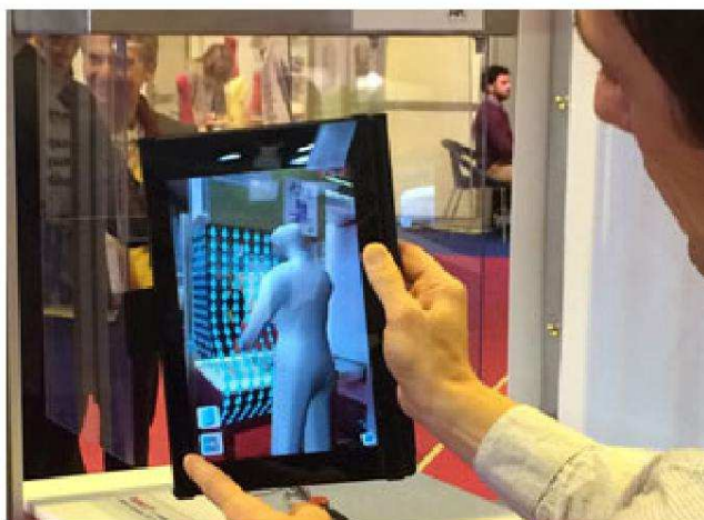
Visualisation, en réalité augmentée, du flux d'air froid ultra-propre sur un démonstrateur Froiloc. (© Irstea)
