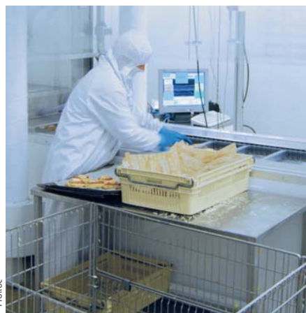
L'air froid descend doucement sans s'écarter du plan de travail, permettant un meilleur confort thermique.
