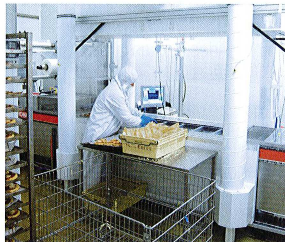
Avec la technologie de froid localisé, le flux d'air ultrapropre entre 0 °C et 4 °C est localisé sur la ligne. L'ambiance de travail est maintenue entre 13 °C et 16 °C.
