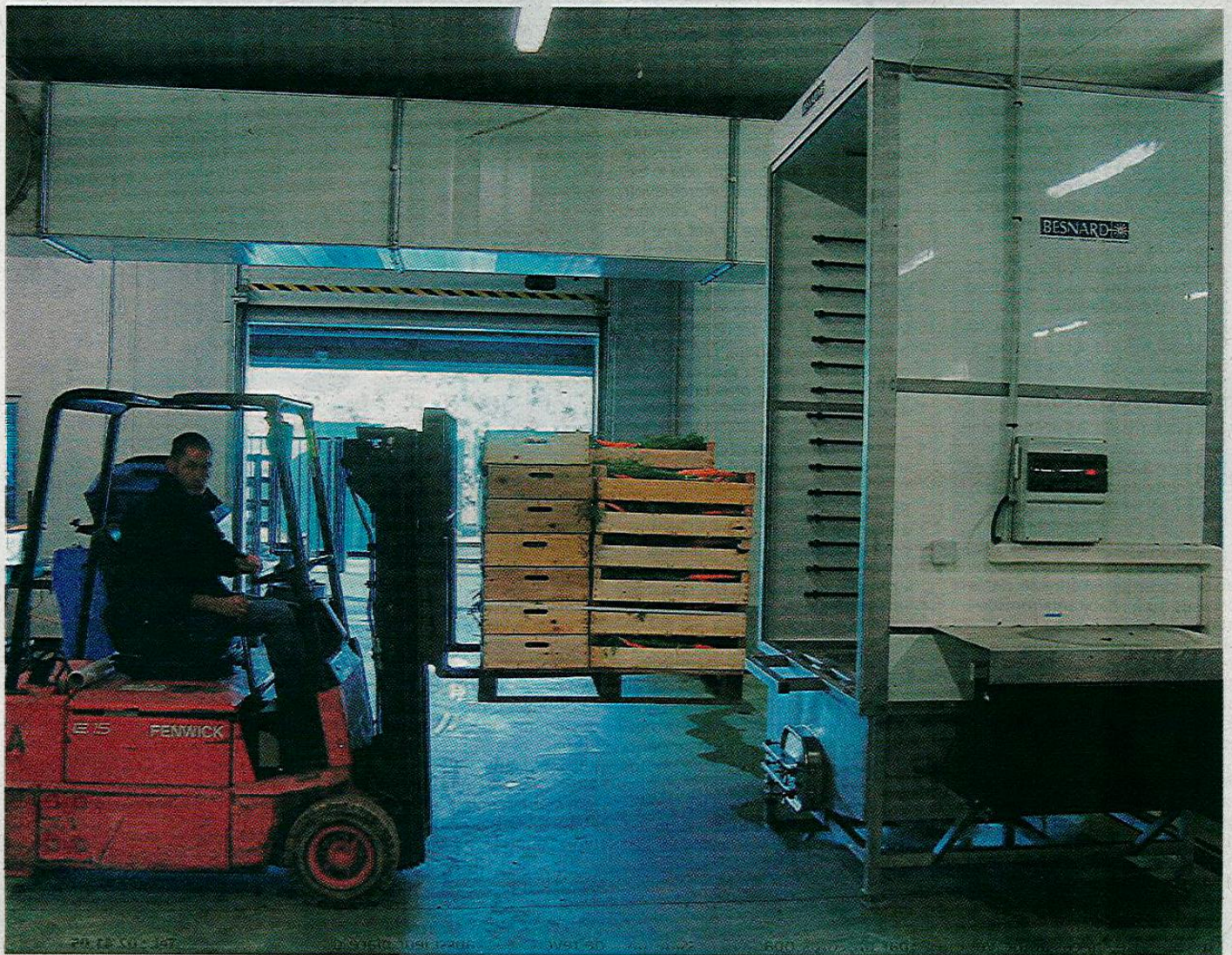
Le caisson conçu par Cesbron permet de refroidir une palette entière de légumes en quelques dizaines de minutes. Photo Groupe Cesbron.
